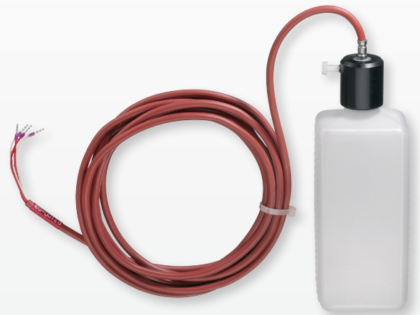
Abb.: Temperaturfühler mit Kontrollflasche als Referenzkörper
